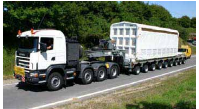
Figure 3 : Conteneur et remorque pour le transport routier du combustible nucléaire irradié : OPG (ci-dessus); Areva (à droite).
