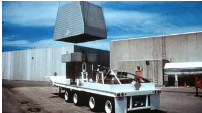
Figure 3 : Conteneur et remorque pour le transport routier du combustible nucléaire irradié : OPG (ci-dessus); Areva (à droite).
