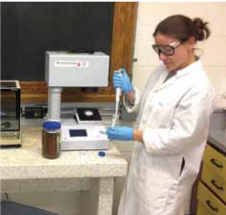
Magda Celejewski, candidate au doctorat à l'Université du Nouveau-Brunswick, étalonne un spectromètre proche infrarouge (PIR) pour déterminer la masse de l'eau extraite de carottes rocheuses à faible porosité à l'aide de papiers-filtres.
