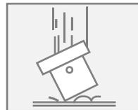
Une épreuve de chute libre d'une hauteur d'un mètre sur une barre d'acier pour vérifier sa résistance à la perforation
