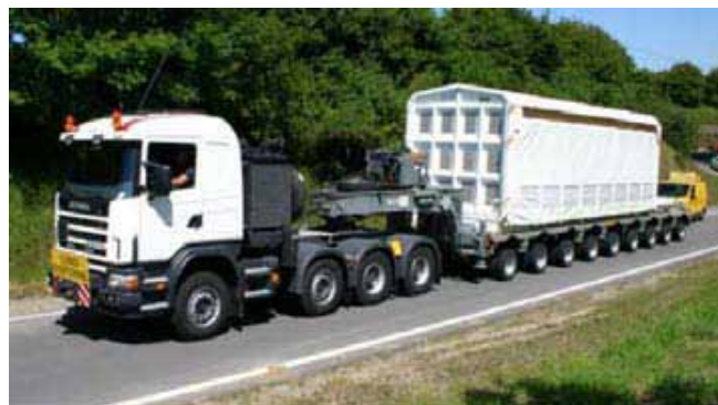
Figure 3 : Conteneur et remorque pour le transport routier du combustible nucléaire irradié : OPG (ci-dessus); Areva (à droite).
