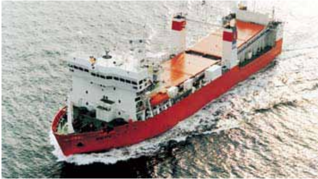
Figure 5 : Navire pour le transport du combustible nucléaire irradié en Suède (ci-dessus); chargement d'un château de combustible nucléaire irradié (à droite). Photos : SKB.
