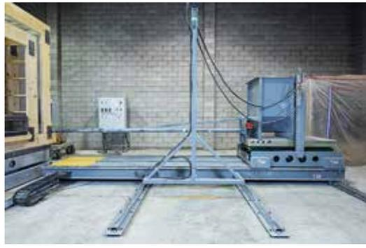
En haut à gauche : Ce prototype de mécanisme à glissement produit par les ingénieurs de la SGDN est conçu pour soulever, transférer et mettre en place la structure de la boîte tampon au sol et aussi pour empiler des boîtes tampons les unes sur les autres.
