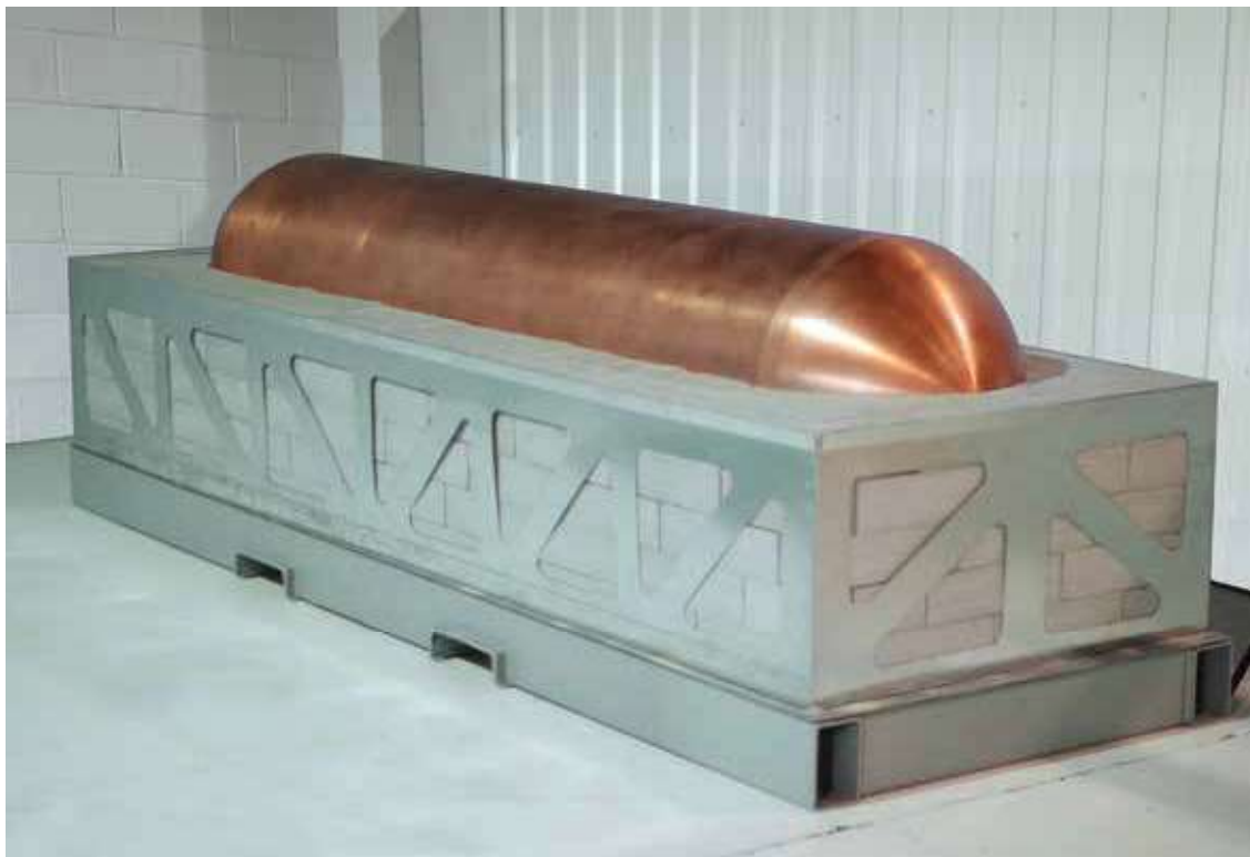
Conteneur entièrement assemblé placé dans une boîte tampon en bentonite.
