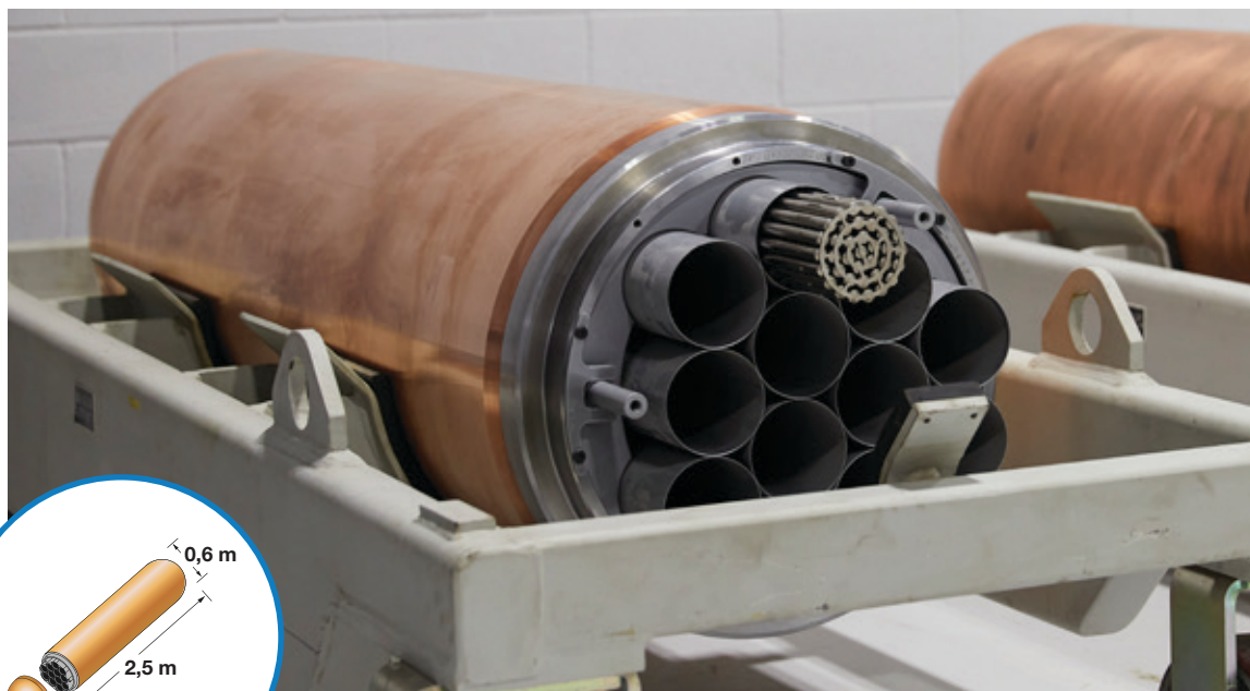
Le Conteneur de combustible irradié de la SGDN peut contenir 48 grappes de combustible et est recouvert d'un revêtement en cuivre résistant à la corrosion.
