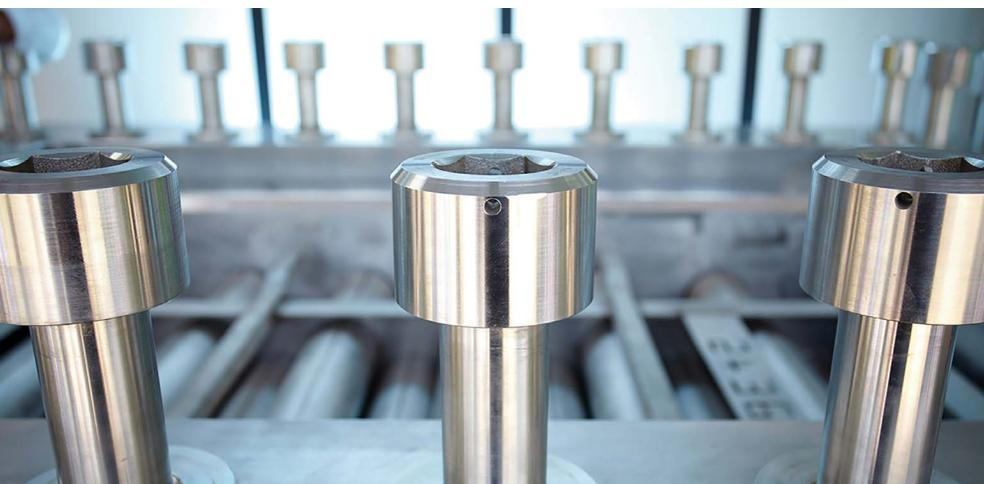
Trente-deux boulons sont insérés dans le Colis de transport du combustible irradié qui pourrait être utilisé pour acheminer le combustible nucléaire irradié depuis les installations provisoires d'entreposage jusqu'au dépôt géologique en profondeur.
