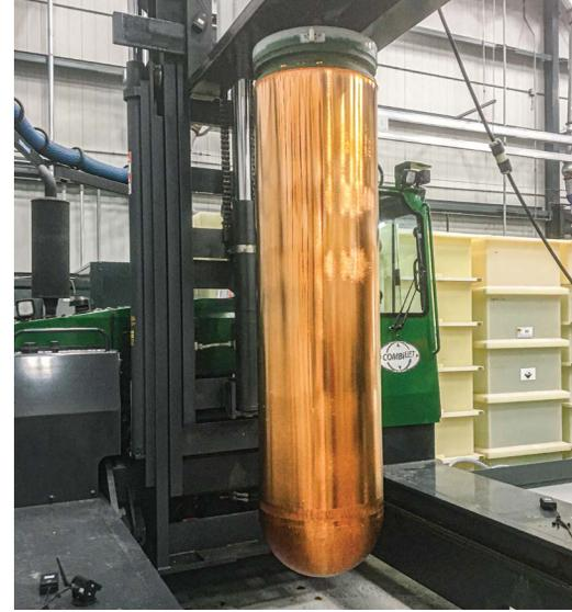
Ces photos montrent les avancées technologiques liées au placage du revêtement de cuivre : Le système de placage en réservoir Nanovate<sup>MC</sup> et les systèmes auxiliaires (à gauche), et un prototype de composant de conteneur revêtu de cuivre produit à l'aide du système de placage (à droite).
