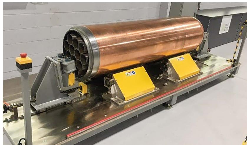
Ces photos montrent un examen non destructif (END) des composants du conteneur de combustible irradié (CCI) : Un spécialiste technique de la SGDN inspecte le revêtement de cuivre (à gauche); de l'équipement de banc d'essai END est utilisé pour faire pivoter le CCI pendant l'inspection (à droite).
