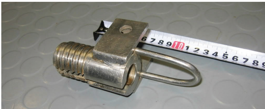
Kuva 4-1. Pidike Virtauseromittarin kivikuppiin.
