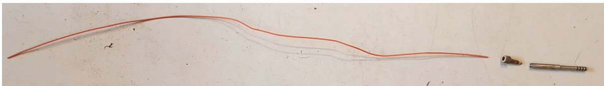
Kuva 2-20. Kapillaariputki ja liittinosat.
