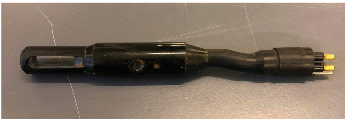
Kuva 2-24. EC-elektrodi ilman huppua ja holkkia.
