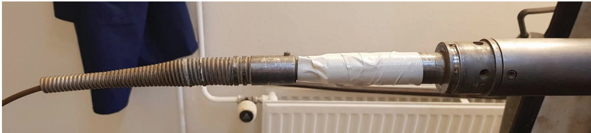
Kuva 3-6. Kaapelipääteen kiinnityksen varmistus teipillä.
