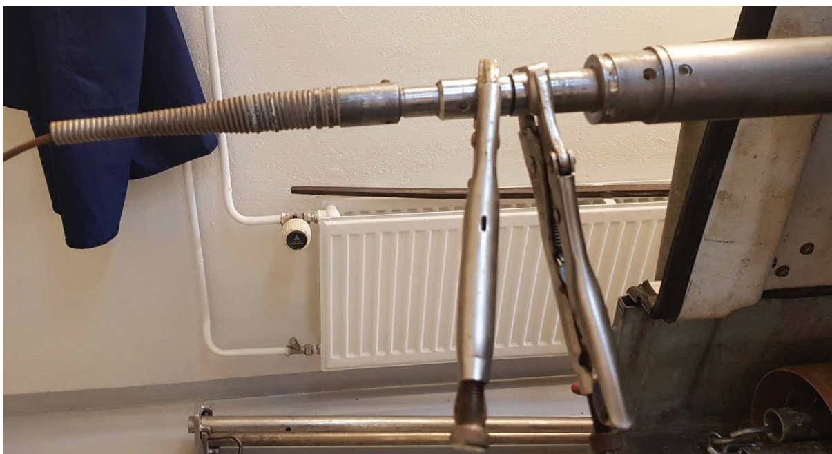
Kuva 3-5. Kaapelipääteen kiinnitysholkin kiristäminen lukkopihtieillä.
