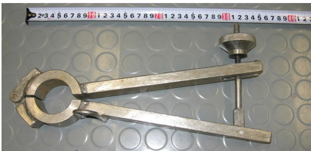
Kuva 4-2. Elektroniikkaputkeen asennettavat pihdit.
