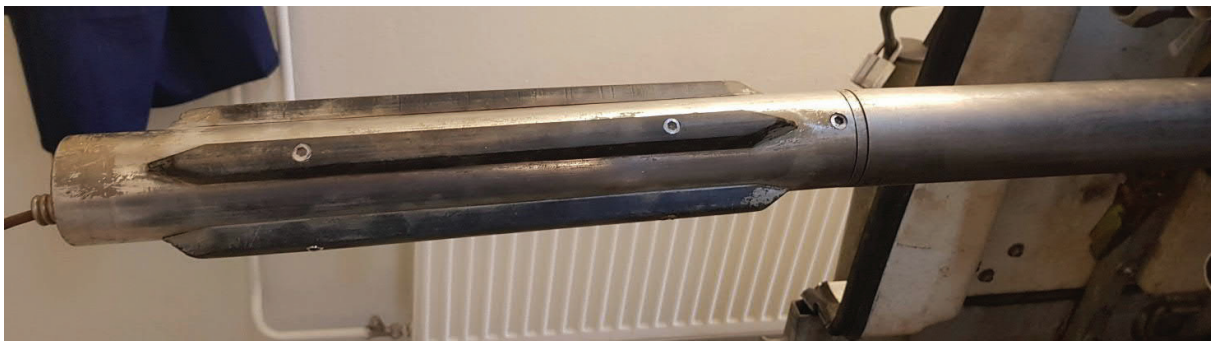
Kuva 3-7. Kivikuppi asennettuna paikoilleen virtauseromittariin.
