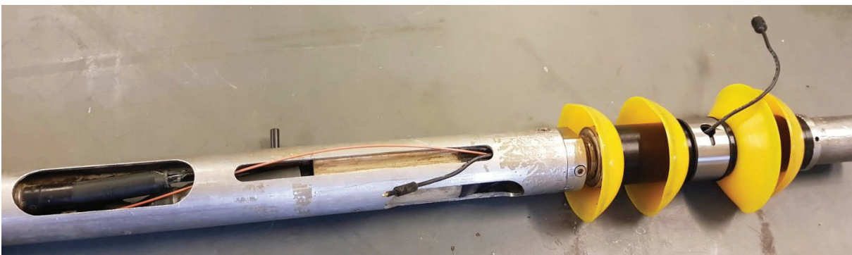
Kuva 2-13. Maadoitusvastuselektrodin johdon pujottaminen.
