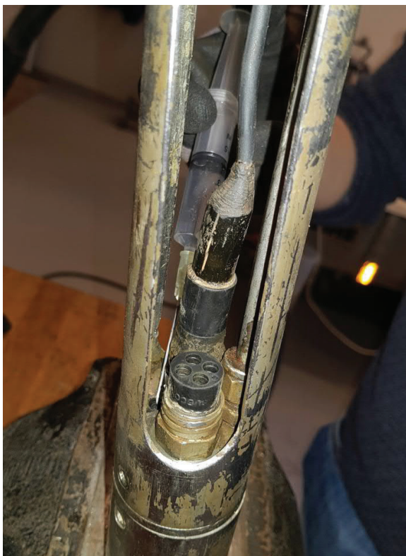
Kuva 2-21. Absoluuttipaineanturin liittimen reiän täyttö akkuvedellä.
