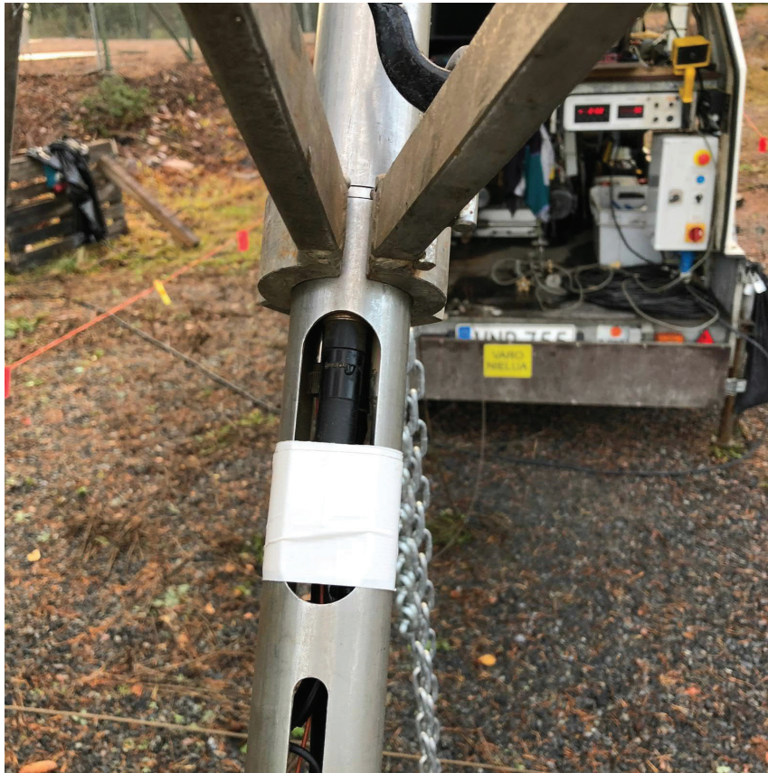
Kuva 4-3. Elektroniikkaputken pihdit paikallaan laskussa.
