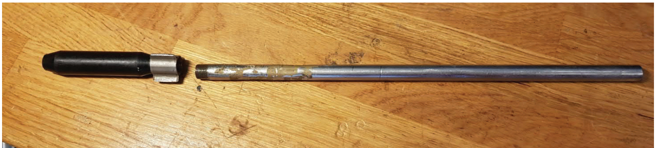
Kuva 2-17. Pystyvirtausohjain (vasemmalla) ja virtausputki (oikealla).
