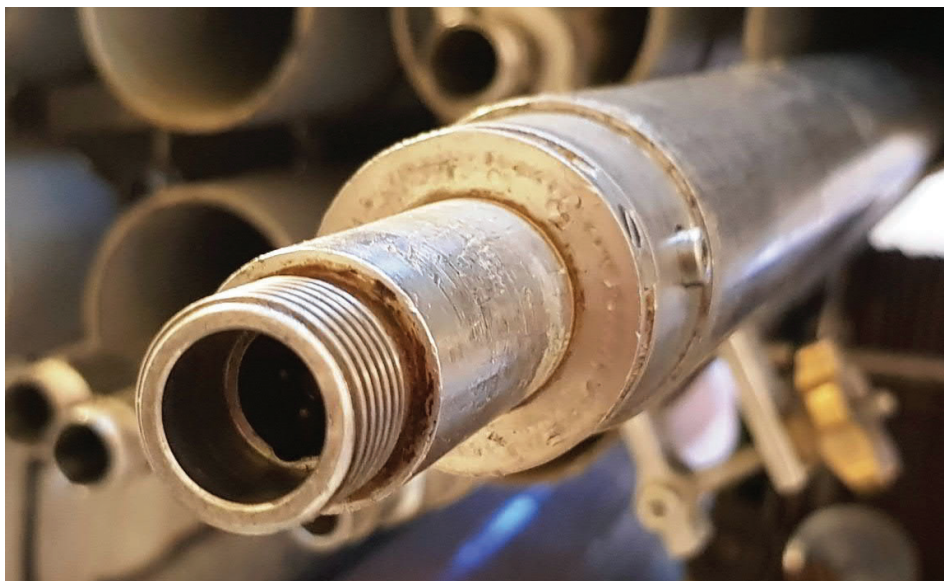
Kuva 3-2. Kaapelipäätteen vastakappale virtauseromittarin yläpäässä. Hahlo näkyy sisällä alareunassa.
