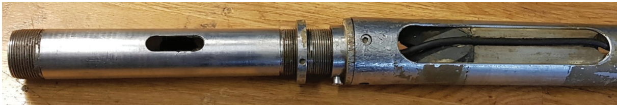
Kuva 2-7. Hetula putki ja sovitin kiinnitettynä virtausanturin suojaan.
