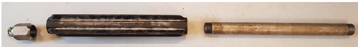
Kuva 2-25. Painolenkki, 76 mm keskitin ja 0.406 m jatkoputki.
