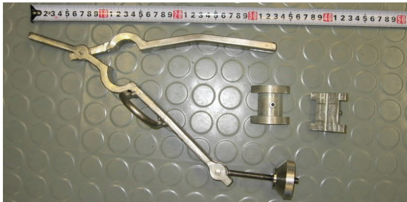
Kuva 4-6. Jatkoputkien pihdit ja kaapeliinsovitussosat.
