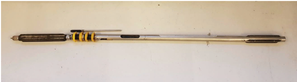
Kuva 2-1 Virtausmittari Reikä-EC-mittauskokoontyössä. Kuvassa pystyvirtausanturi ja virtausputki on otettu virtausmittarin viereen esille.
