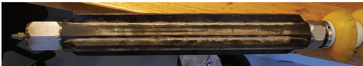
Kuva 2-27. Jatkoputki, keskitin ja painolenkki asennettu paikoilleen.
