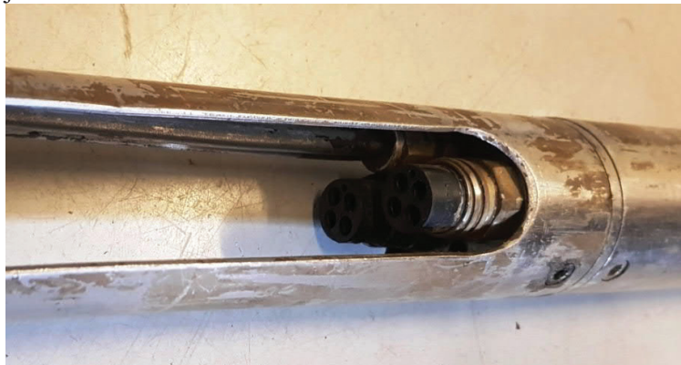
Kuva 2-4. Virtausanturin suojaputki, jonka sisällä alapäätykappaleen Subconn-liittimet.
