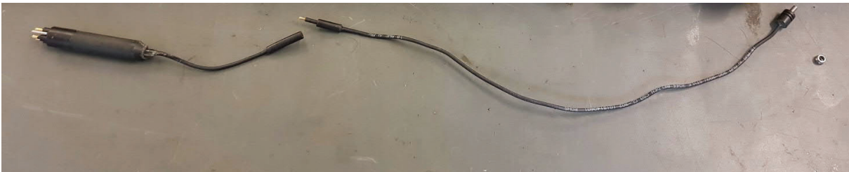
Kuva 2-12. Uudenmallisen maadoitusvastuselektrodin kaksiosainen johdin.
