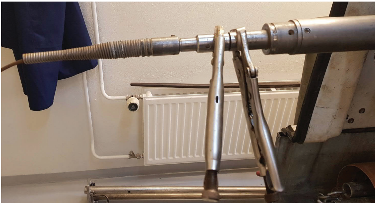
Kuva 3-5. Kaapelipääteen kiinnitysholkin kiristäminen lukkopihtieillä.
