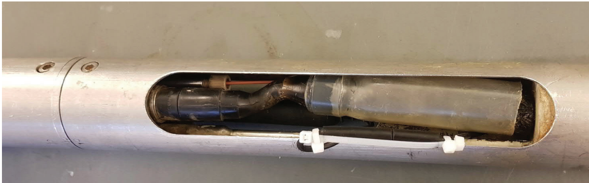
Kuva 2-16 Maadoitusvastuselektrodin johtimen liitoksen varmistus valmiina.
