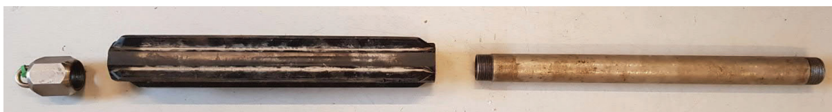
Kuva 2-25. Painolenkki, 76 mm keskitin ja 0.406 m jatkoputki.
