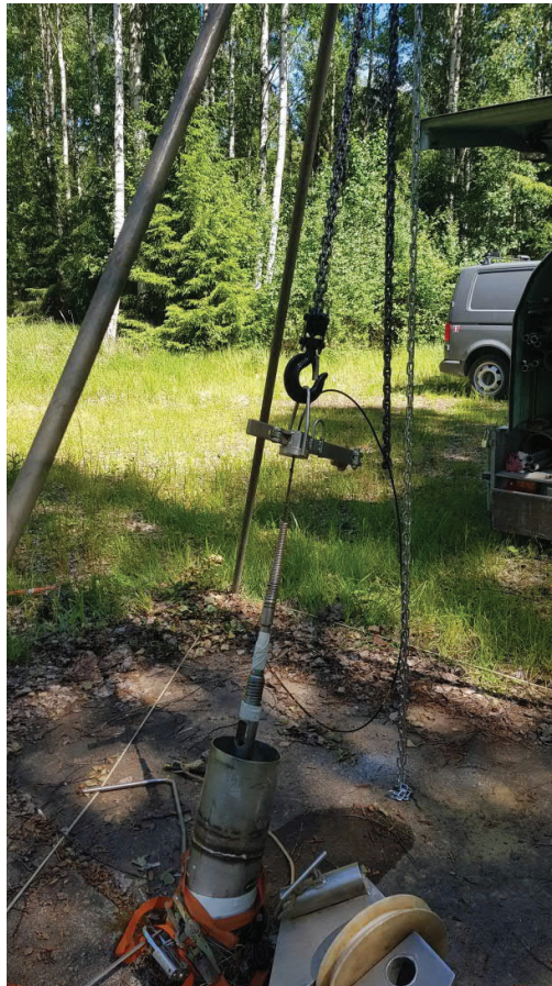
Kuva 4-8. Virtauseromittarin lasku kaapelista.
