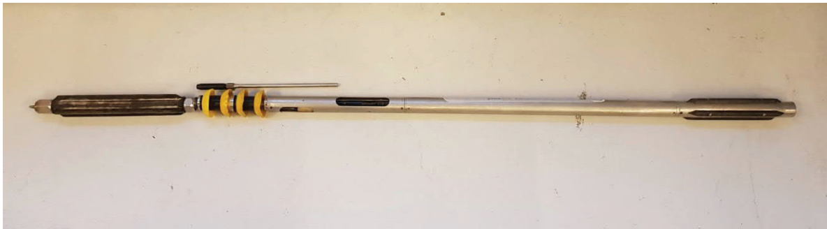
Kuva 2-1 Virtausmittari Reikä-EC-mittauskokoontamassa. Kuvassa pystyvirtausanturi ja virtausputki on otettu Virtausmittarin viereen esille.
