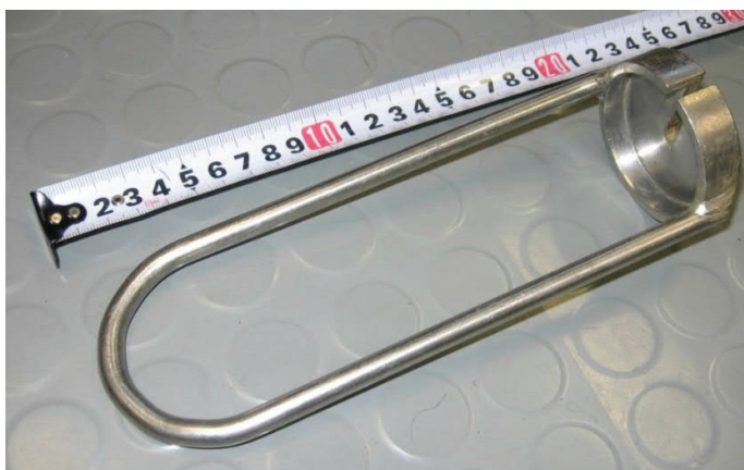
Kuva 4-7. Taljaankiinnitysosa jatkoputkien pihteihin.
