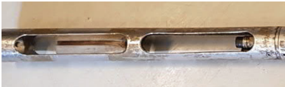
Kuva 2-5. Ominaisvastuselektrodin johdon ura virtausanturin sivulla.
