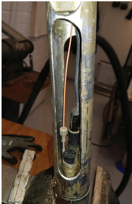
Kuva 2-22. Kapillaariputki asennettuna paikoilleen.
