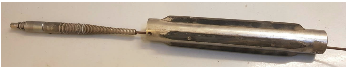
Kuva 3-3. Kaapeli ja kaapelipääte pujotettuna kivikupin läpi.
