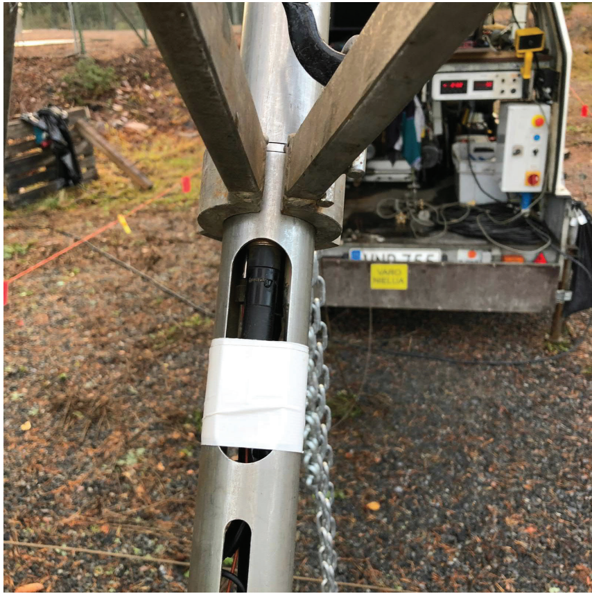
Kuva 4-3. Elektroniikkaputken pihdit paikallaan laskussa.
