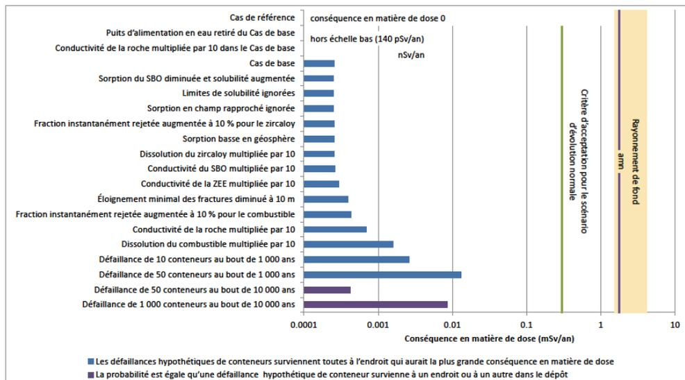
Figure E1 : Résultats des analyses de sensibilité et des évaluations limitatives
