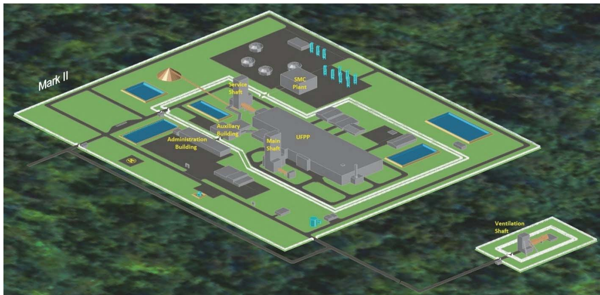
Principales installations de surface du DGP
